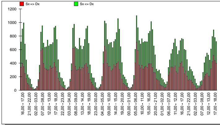
Rilievo sulla S.P. 358R: flusso orario nella settimana di rilievo
